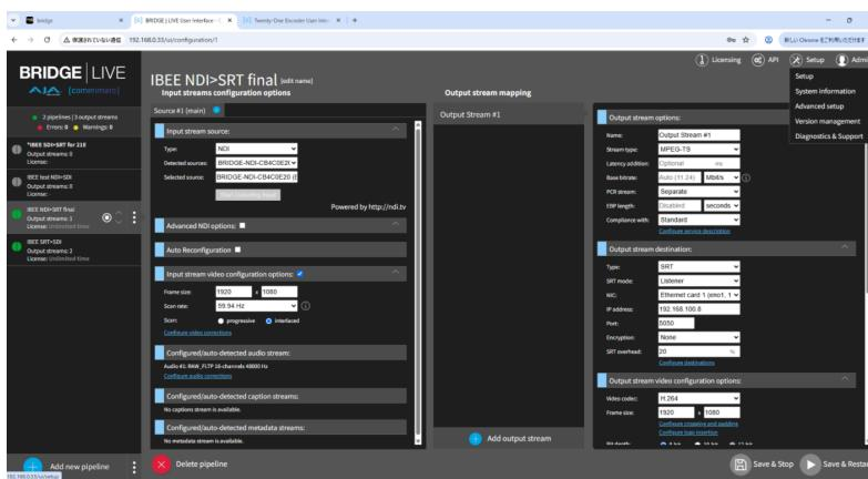
画面右上Setupをクリックすると以下IPアドレスを設定する画面に推移します。2つのLANポートの役割を設定します。
