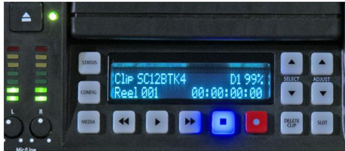
メディアを取り外す場合は、必ずSLOTボタンを押して下さい。そして画面のクリップ名とリール番号に「N/A」、メディアの残り容量に「No Slot」と表示され、グリーンLEDが消灯していることを確認して下さい。この状態は、メディアを安全に取り外せる状態であることを意味します。ストレージメディアを取り外す時は、本体正面左上のメディアリリースボタンを左手で押しながら、右手でメディアを水平に引き抜きます。
