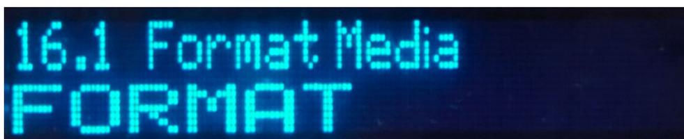
リール番号設定後、“16.1 Format Media”でメディアをフォーマットします。ADJUSTボタンを押して、“FORMAT”に設定し、さらにADJUST ↑ ボタンを押すと、以下の画面が表示されます。
