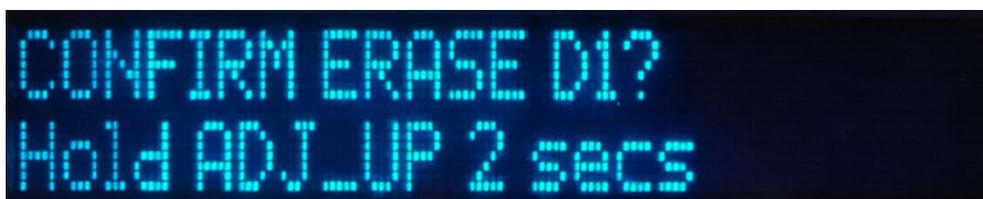
画面表示(Hold ADJ\_UP 2 secs)に従い、ADJUST ↑ ボタンを2秒間押し続けると、フォーマットが開始されます。フォーマットが完了すると画面上に“Format D1 Complete”と表示されます。
