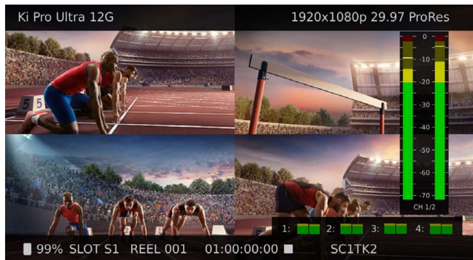
図10. フロントパネルでのオーディオメーターの表示の例
