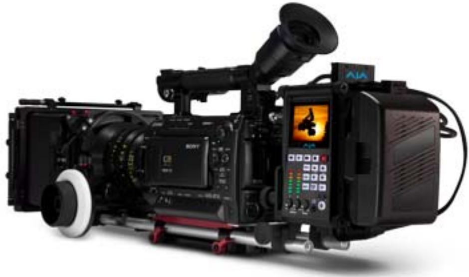
Figure 7. オプションのマウントプレートを使ってカメラに取り付けた例
