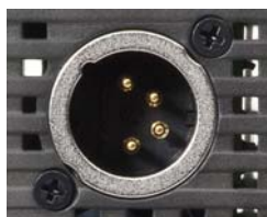
4 ピン XLR コネクタを Ki Pro Quad の DC12V ソケットに接続します。
