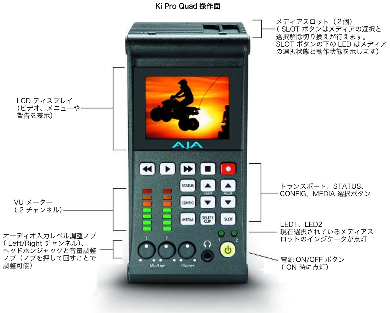
Figure 2. Ki Pro Quad 操作面の各部
