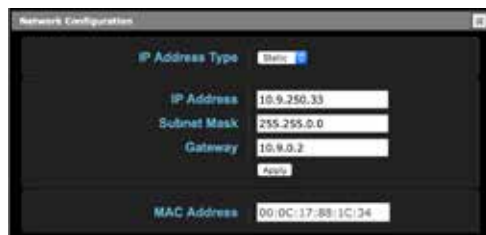
図 24. [Network] パネル、固定 IP
